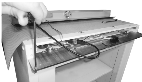
13. Tighten pivot (2,5 mm allen key)
