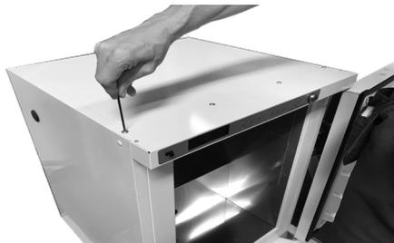
2. Dévissez et retirez les vis supérieures visibles (à l'aide d'une clé 6 pans 3 mm et d'un tournevis Torx 20).
