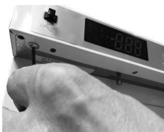
4. Retirez les vis situées sous le panneau supérieur (à l'aide d'une clé 6 pans 3 mm).
