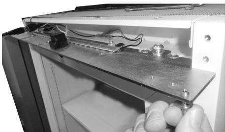
11. Dévissez l'axe supérieur de la porte (à l'aide d'une clé 6 pans 2,5 mm si nécessaire).
