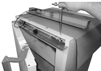
39. Serrez les deux vis M8 sur le support supérieur.
