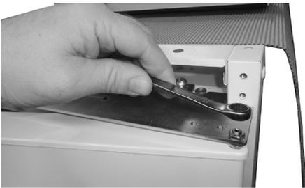
9. Loosen pivot nut (use 10 mm spanner)
