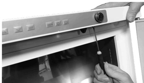
5. Retirez la goupille de blocage (à l'aide d'un clé 6 pans 4 mm).
