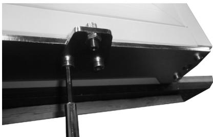
29. Remontez la plaque inférieure de goupille de blocage du côté opposé en revissant les deux vis (à l'aide d'une clé 6 pans 4 mm).
