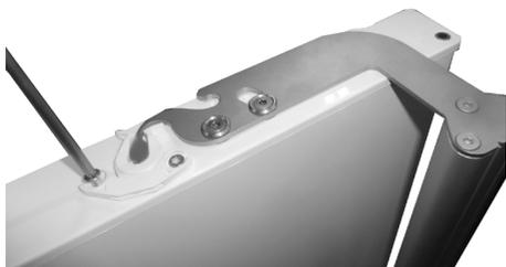
31. Passez au bas de la porte et dévissez les deux vis du ferme-porte (à l'aide d'un tournevis Torx 20).
