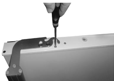
35. Dévissez les deux vis de ferme-porte dans ce nouveau bas de porte (à l'aide d'un tournevis Torx 20).
