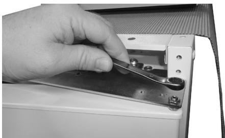
9. Dévissez l'écrou d'axe (à l'aide d'une clé 10 mm).
