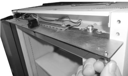
11. Loosen door top pivot (use 2,5 mm allen key if necessary)
